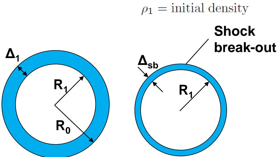
$$m_{\text{sb}} \sim 4\pi R_1^2 \Delta_1 \rho_1 = 4\pi R_1^2 \Delta_{\text{sb}} \rho_{\text{sb}}$$
