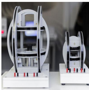
圖十九 三軸的亥姆霍茲線圈 [6] 。
