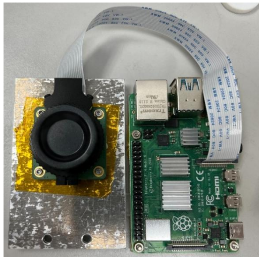
圖十一、貼上絕緣膠帶的相機板
