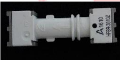
圖 5-1-2 光耦合訊號對(Optical coupling)。
