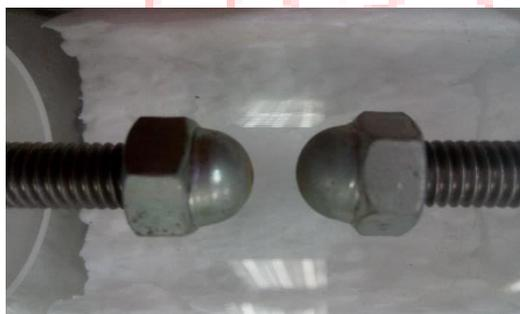
圖 3-3-1 第一代間隙開關之電極。
