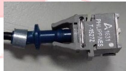
圖 5-1-3 接受器(Receiver)和轉換器(Transmitter)。
