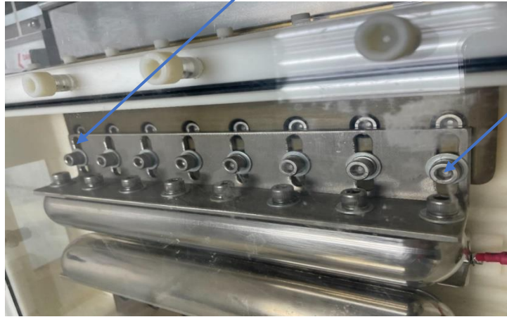
圖 3-7：半圓形電極與軌道間隙開關下方利用接著的是 L 形金屬板相連，L 形金屬板較長的部分與下方相連，較短的部分接半圓柱電極。
