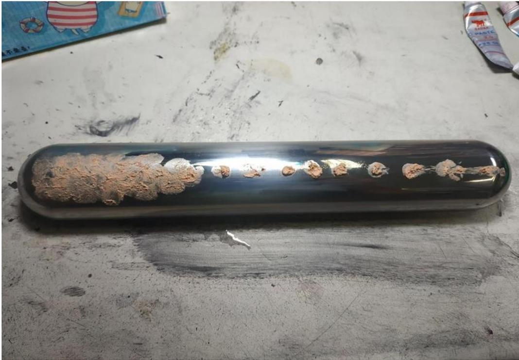
圖 14 將鑽石膏均勻塗抹在電極上
