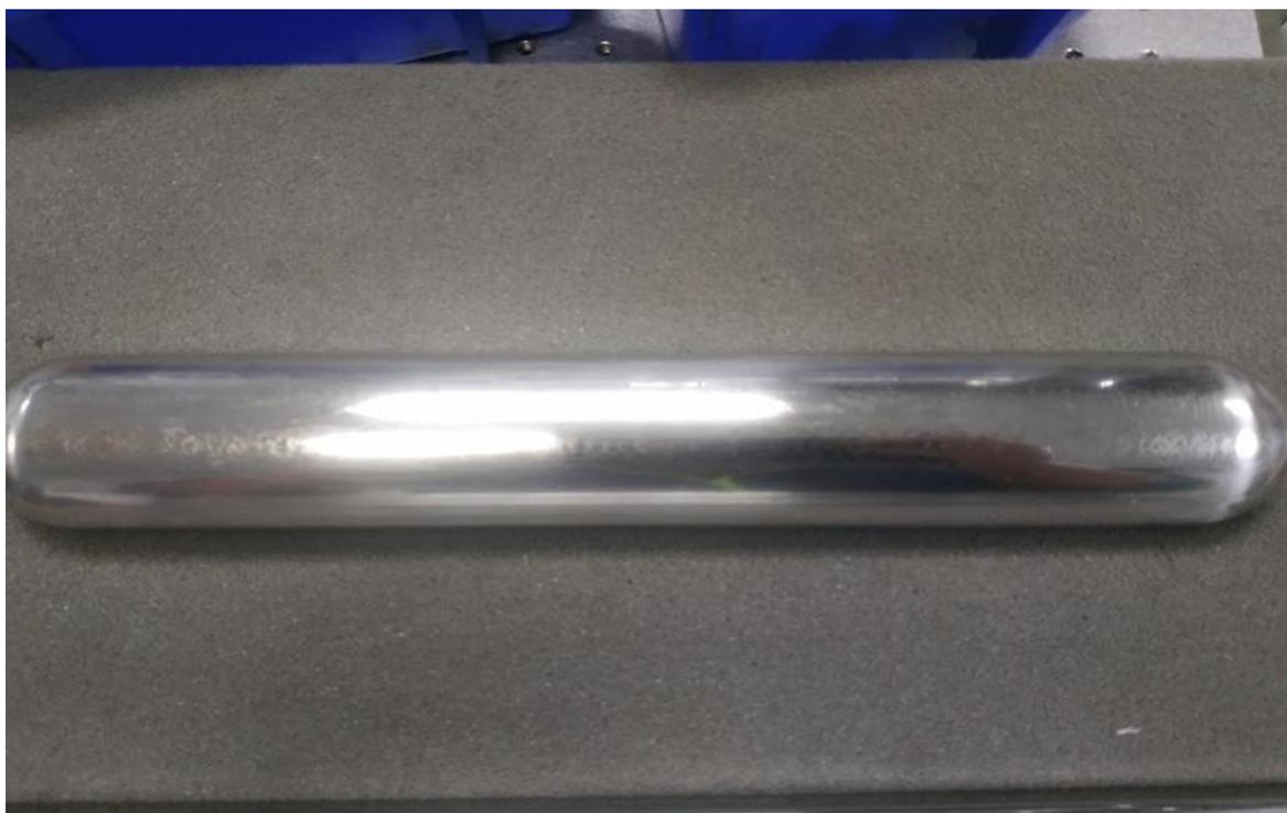
圖 13 用砂紙研磨後照片
