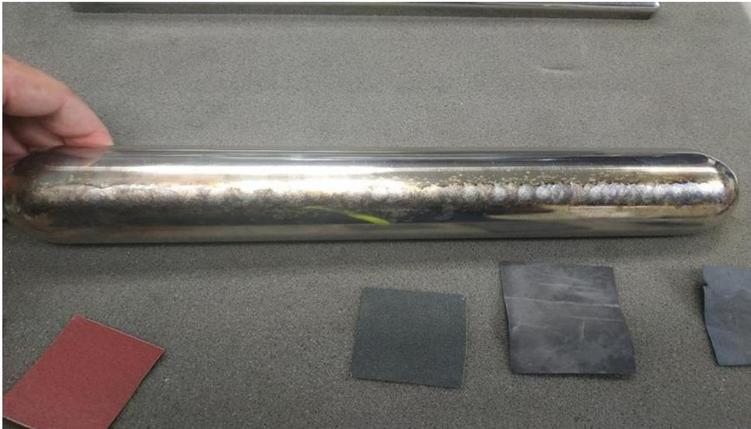
圖 11 未拋光前電極照片(有燒焦痕跡)
