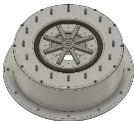
圖十二(a) 下盤鎖至同軸傳輸線
