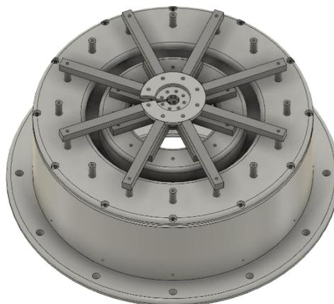
圖十二(b) 上盤鎖至同軸傳輸線
