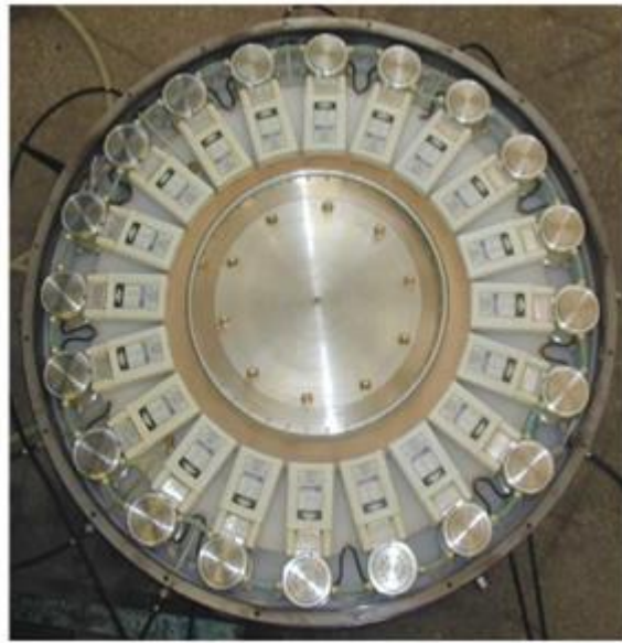
圖2-1-2 LTD 內部 20 個 bricks 結構俯視圖。這邊由 20 個 bricks 並聯而成，來使輸出的電流疊加成大電流。以 A.A Kim 的 LTD 為例(如圖 2-1-2 所示) [2]，總共有 20 個 bricks 並聯，每一個 brick 裡面由兩個 40 nF 的電容和一個開關串聯，開關兩側的電容充電至 \pm 100 KV，因此 switch 的工作電壓必須至少能夠承受 200 KV。此設計 LTD 可以輸出 0.5 MA。
