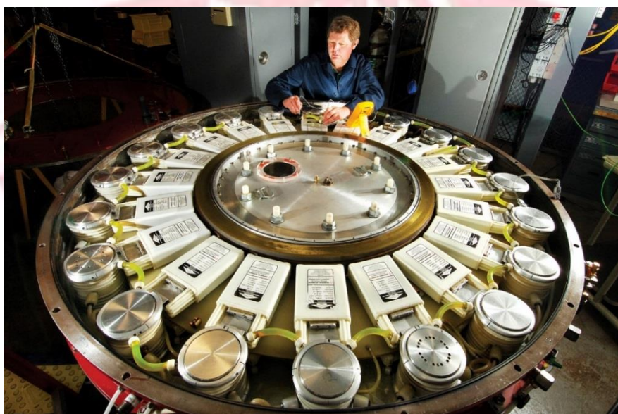
圖1-1-1 多個單元(brick)並聯而成的 LTD 系統，每一個 brick 則由兩個電容和一個開關串聯而成。
