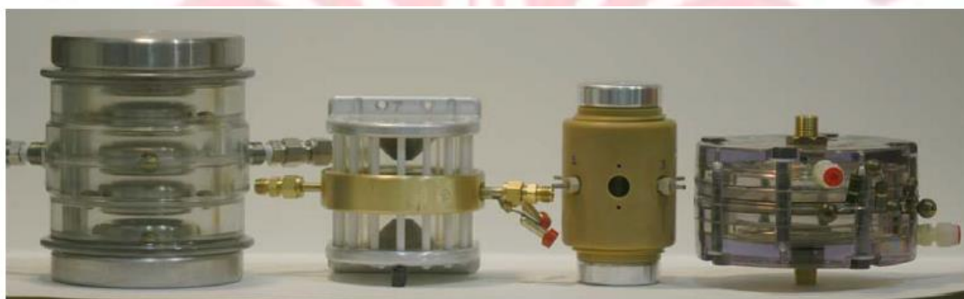
圖 2-2-1 由左而右分別為 HCEI、Sandia、Kinetech 和 L3 等的單位製作的開關。
