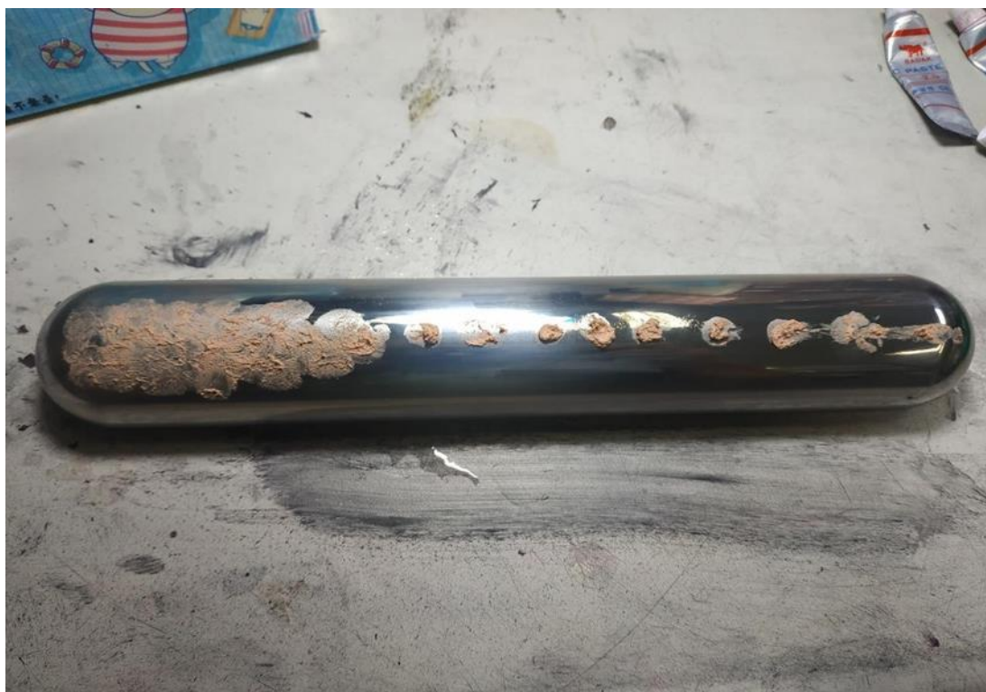
圖 4 將鑽石膏均勻塗抹在電極上
