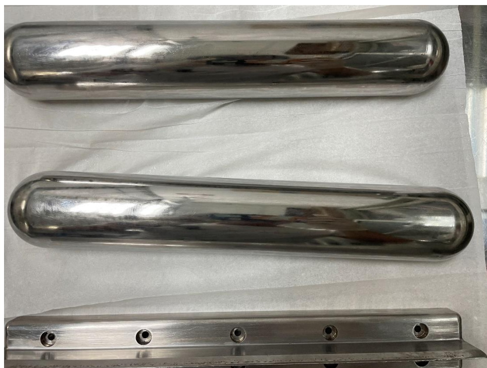
圖 5 用電動拋光機研磨完照片
