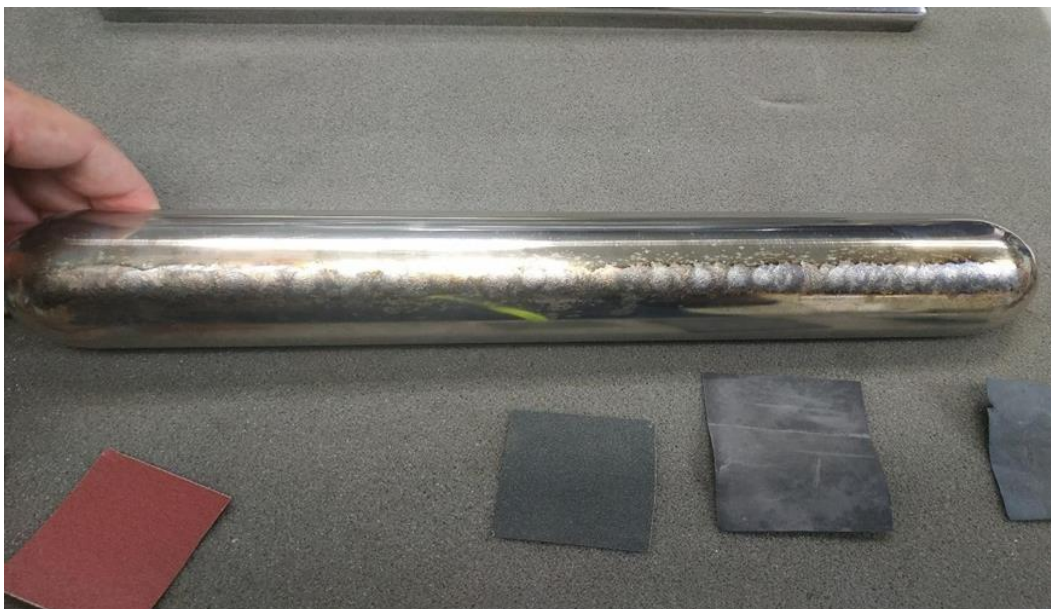
圖 1 為拋光前電極照片(有燒焦痕跡)
